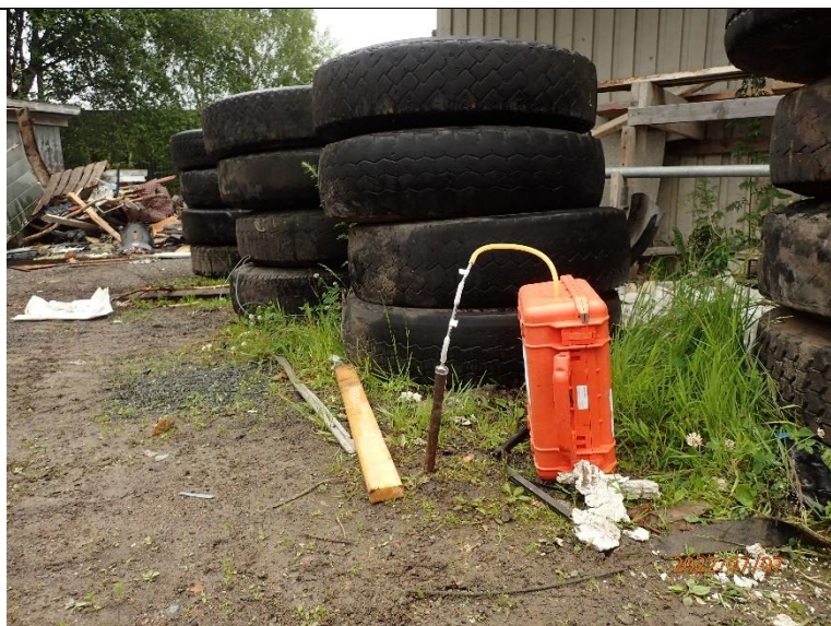
Närbild av provtagningsutrustningen med seriekopplade adsorbentrör. Provtagningspunkt PG3.
